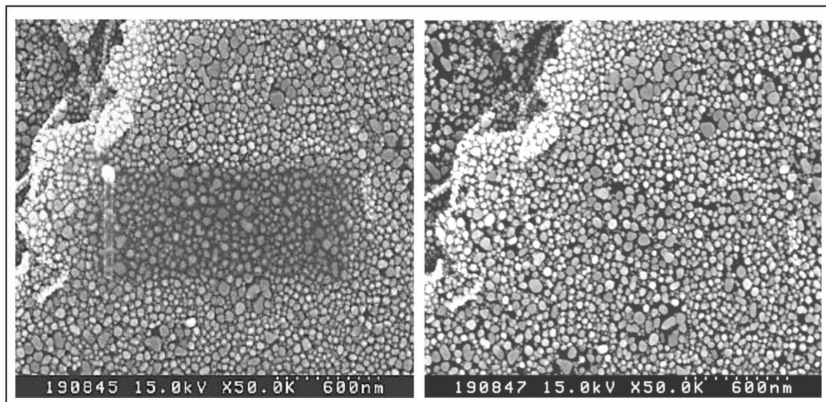
金蒸着粒子のプラズマ照射によるコンタミネーション除去効果事例
